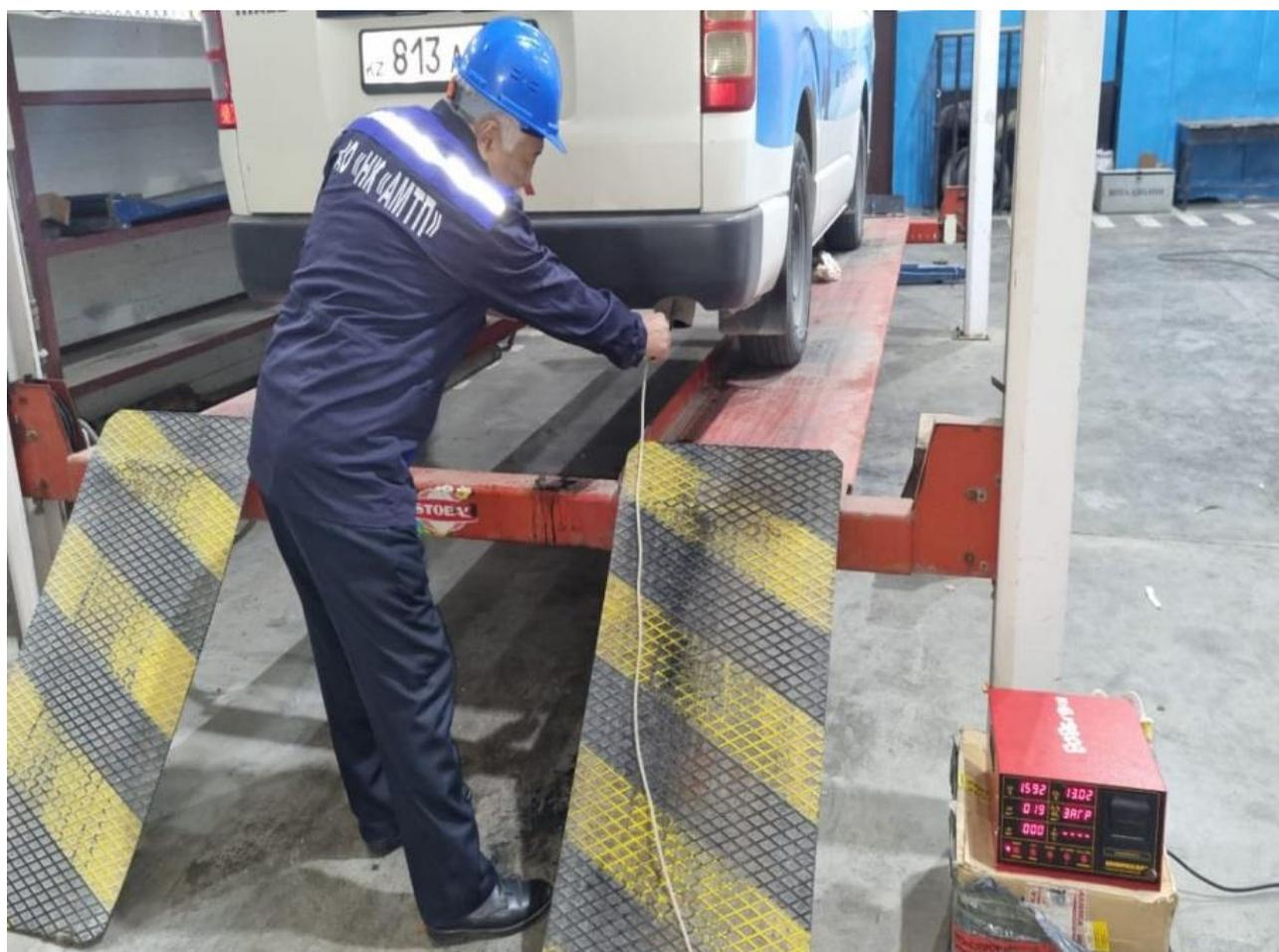
**Процесс осуществления замеров выхлопных газов на содержание СО и СН на газоанализаторе**
