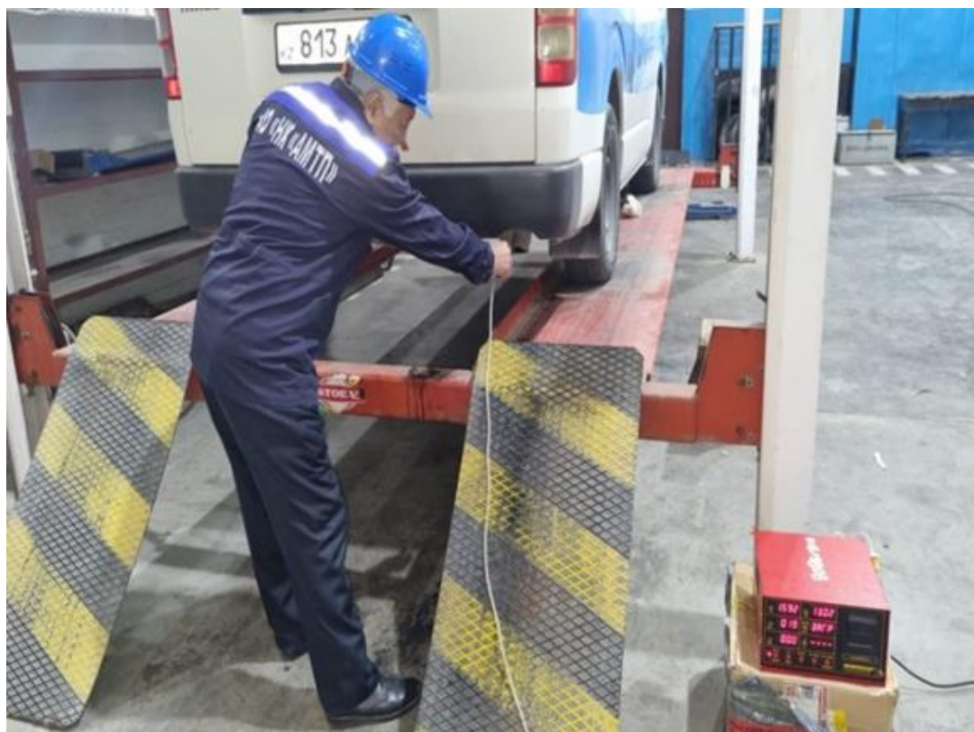
Процесс замеров выхлопных газов на содержание СО и СН на газоанализаторе
